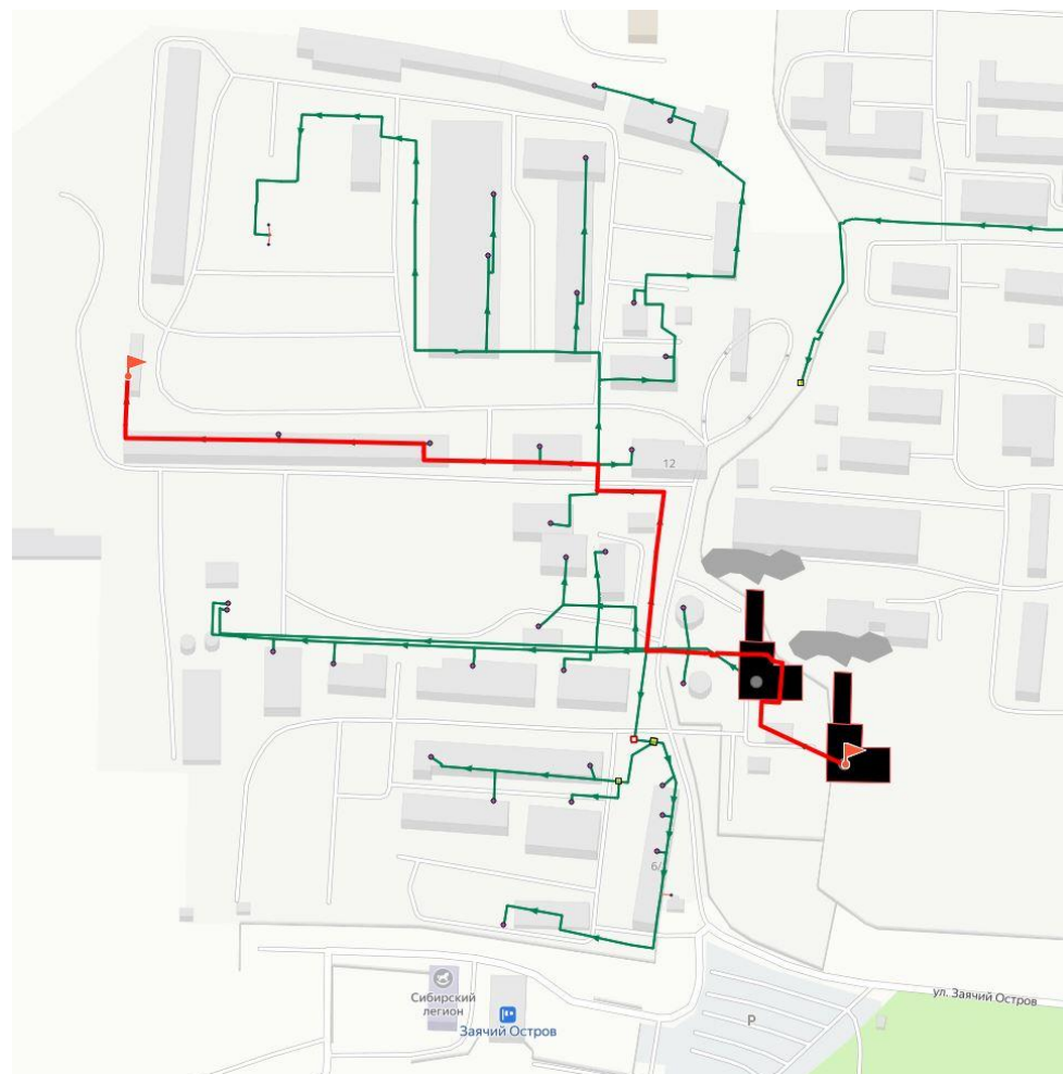
Рисунок 3.63 – Путь движения теплоносителя от источника тепловой энергии до конечного потребителя, в зоне действия котельной №7 ПАО«Сургутнефтегаз» (рисунок П46.1 МУ)
