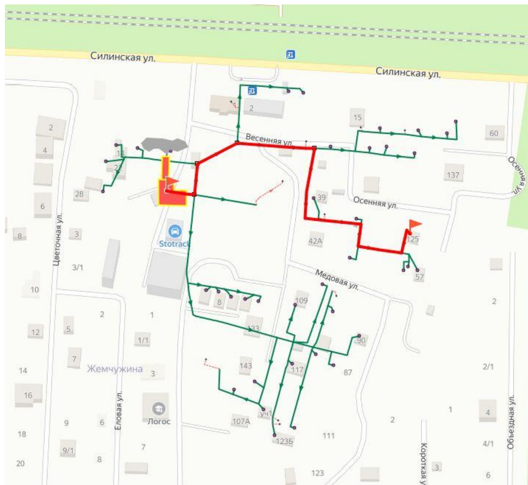
Рисунок 3.35 – Путь движения теплоносителя от источника тепловой энергии до конечного потребителя, в зоне действия котельной №25 п. Лесной (рисунок П46.1 МУ)
