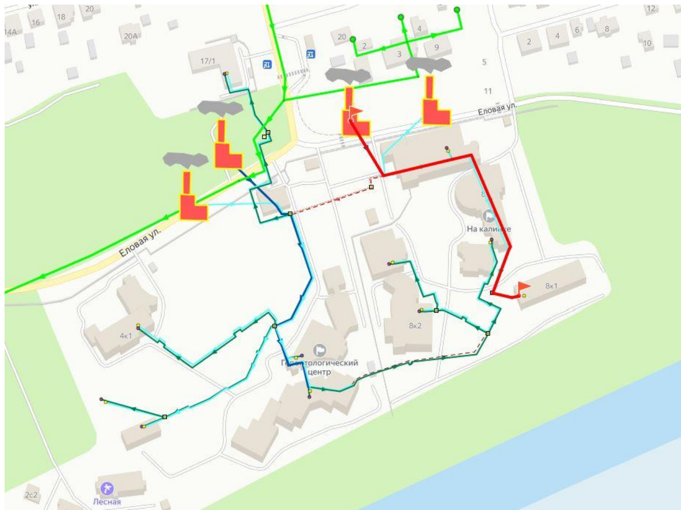
Рисунок 3.47 – Путь движения теплоносителя от источника тепловой энергии до конечного потребителя, в зоне действия котельной №32 п.Снежный (рисунок П46.1 МУ)
