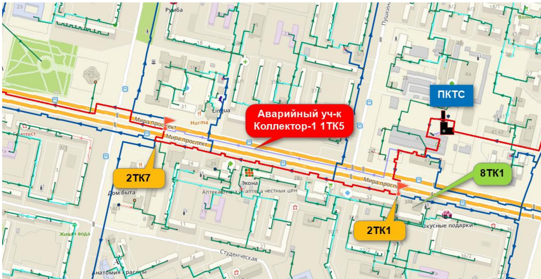
Рисунок 9.21 – Смоделированная аварийная ситуация. Альтернативный путь движения теплоносителя
