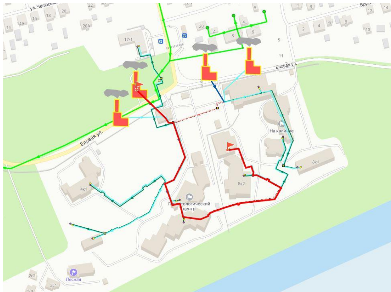
Рисунок 3.49 – Путь движения теплоносителя от источника тепловой энергии до конечного потребителя, в зоне действия котельной №33 п. Снежный (рисунок П46.1 МУ)
