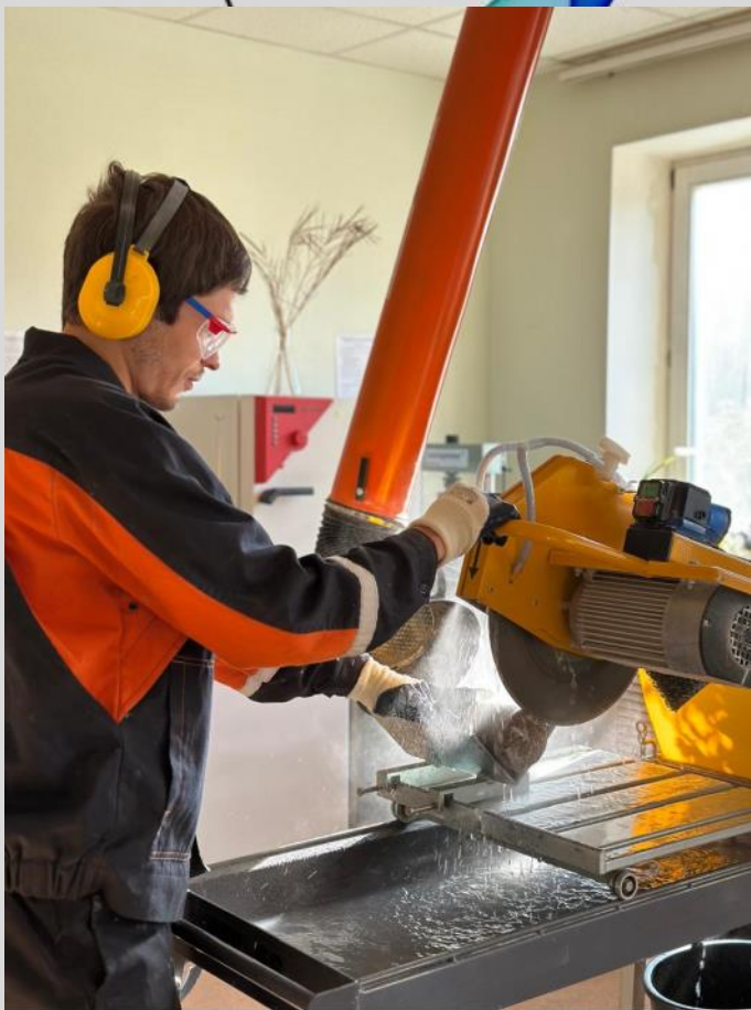
Фоторабота «Подготовка геологических проб к испытанию»
