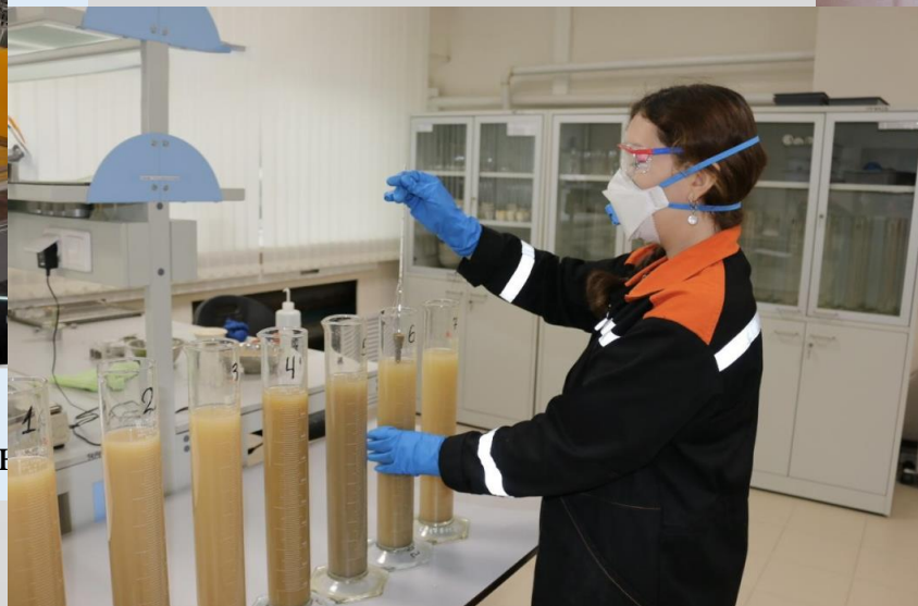
Фоторабота «Процесс третьего замера суспензии в мерном цилиндре ареометром для грунтов»
