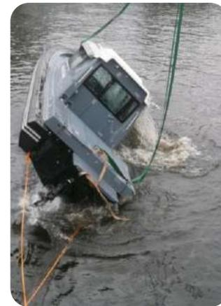
Компания «Скоростные катера МГ» провела испытания в 2016 году по полному перевороту вдоль ДП катера проекта 860 К на 360 градусов в инициативном порядке, в антиштормовом (всепогодном) классе безопасности. В ходе испытаний были выявлены специальные возможности самовосстановления катера на разных углах крена.
