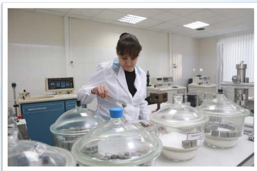
Отбор коллекции образцов для проведения капиллярных исследований
