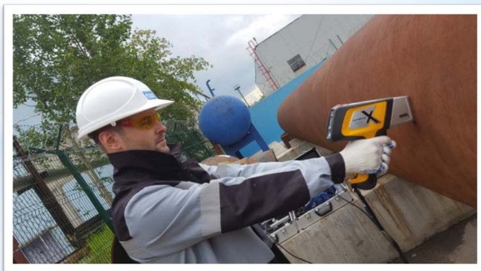
Инженер по наладке и испытаниям проводит спектральный анализ химического состава металла труб.
