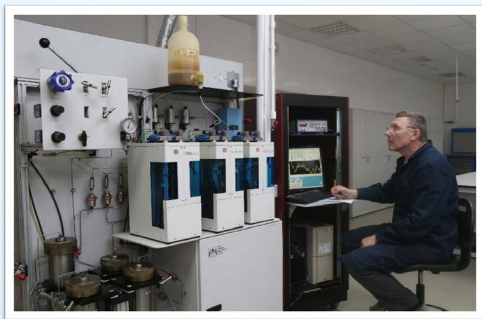
Контроль давления всестороннего обжима модели пласта
