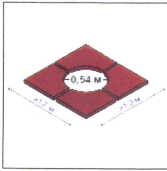
Рисунок 29. Рекомендуемый размер защитной приствольной решётки
