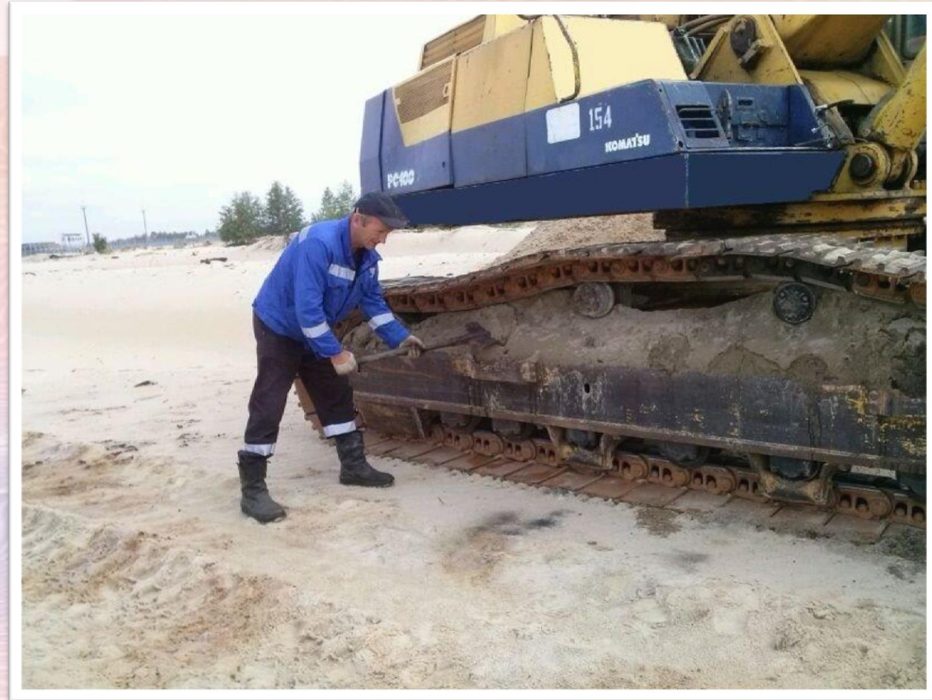
Очистка техники в конце рабочей смены
